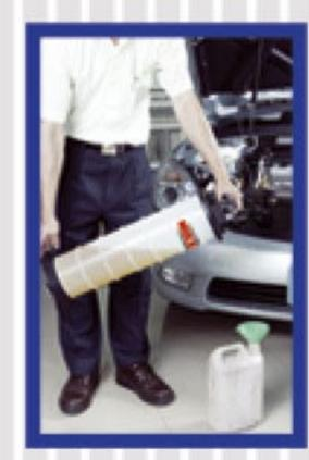
Vacíe el contenido: Remueva la manguera del extractor. Vacíe el aceite en un recipiente adecuado, presione la válvula metálica durante 5 segundos para liberar la presión del aire.
