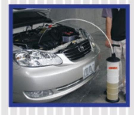
Bombeé varias veces hasta crear un vacío que automáticamente hará que el aceite fluya. Cuando el nivel de aceite llegue al tope del recipiente, el flotador interno activará la válvula de liberación deteniendo la extracción automáticamente.
